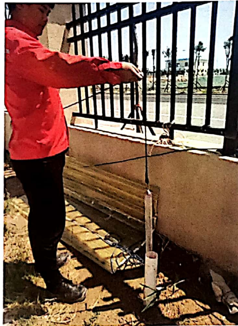
图 4 2#点地下水采样照片
